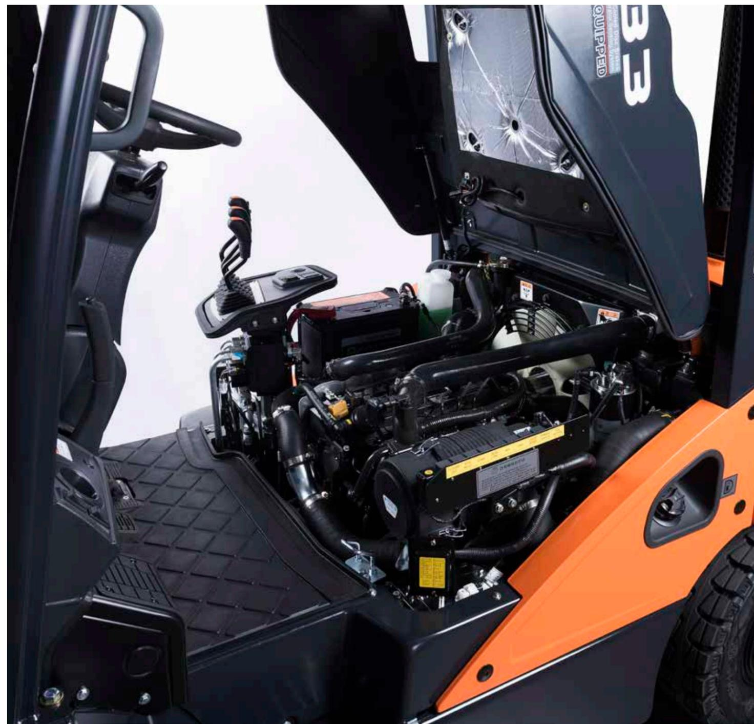
Unser leistungsstarker LPG-Motor entspricht den aktuellen Umweltvorschriften. Er bietet ein hohes Drehmoment bei niedrigen Motordrehzahlen, hilfreich beim Laden an Rampen oder bei schnellen Hubgeschwindigkeiten.
